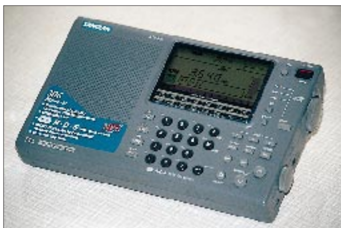
Der Weltempfänger ATS-909 überzeugt neben seinem ordentlichen UKW-Empfang speziell den Funkamateurl durch gute Kurzwelleneigenschaften. SSB- und CW-Stationen lassen sich mittels des großen Abstimmknopfes auf der rechten Seite in 40-Hz-Schritten feinfühlig abstimmen.
